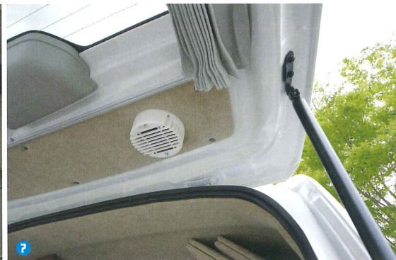
⑦意外と効果が高いというリヤゲートのベンチレーターは標準装備。ボディにはなるべく余計な穴を開けたくないというビークルの思想にも共感できたとのことだ ⑧ノーマルではオーディオの音が後部座席にはほとんど届かないので、オプションでリヤスピーカーを装備した
