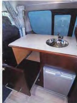
●サイドキッチンを採用した車両は多いが、このモデルは十分な奥行きを持たせ天板面積を拡大。下部はスライド式の収納庫で、電子レンジが余裕で置ける。サイドの収納庫も便利な作りだ
