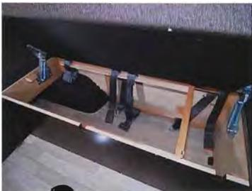
●左右の横座り対面シートは簡単に座面が持ち上げられ固定できる。右は電装品やヒーターユニットがあるが、左はフルに使用して後部収納庫と貫通してある。左右とも2点式シートベルトがあり、ガッシリとアンカーが固定されているのが一目りょう然だ
