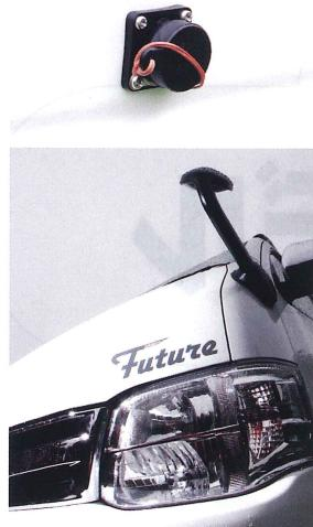
●写真上は外部のAC100V電源を車内に引き込むコネクター。ボディにはこれ以外、キャンピングカー然とした加工はされていないので、普段使いでも気負わずワゴン車として使用できる。車体のフロントとサイドに、デビューから同じデザインの英字ロゴが入る
