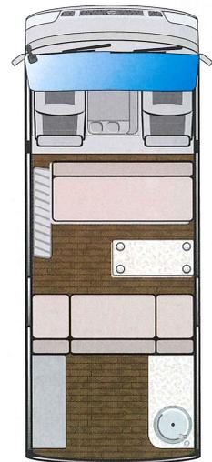
①ギャレーカウンターは冷蔵庫と一体化され、ちょうど良い高さで使いやすいものになっている。②ドリンクホルダー付のテーブルを挟んで対面するダイネットは、ゆったり座れる。③二段ベッドも標準装備。1800mmの長さがあるので大人も楽々就寝できる。二段ベッド下は収納スペースとして利用できる。④展開も簡単なメインベッドは2100×1500mmの広さ。フラットなベッドは大人3人が就寝可能。⑤セカンドシートを前向きにすることで全員前向きの7人乗車ができる。⑥リア部には扉付の収納庫も用意される。扉は引き上げてから奥に収納できる仕組みとなっており、荷物の出し入れも楽。⑦ギャレー下にはカセットコンロ等が機能的に収納できる。
