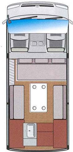
①リア左側部には引き出し式のシンクを収納。またリア右側には調理台が収納されており、両方を引き出せば引き出してギャレーとして使用できる。バックドアを開けた車外からの使用も可能。②コの字型のダイネットは家族で家族等で使用するのに便利な作り。各所へのアクセスも良く使い勝手が良い。③オプションになるが二段ベッドの設定もある。家族でのクルマ旅にはもってこいの仕様だ。④メインベッドと二段ベッドを設置した状態でもリア部には広いスペースがあり、荷物の収納に便利。⑤セカンドシートは走行時は前向き設定ができる。3点式シートベルトも左右2ヶ所に装備。⑥セカンドシートとサードシートを展開させることでメインベッドとなる。またサードシートのみをベッドにすることも可能。⑦シンクのシャワーは車外での使用も可能。折りたたみ式のテーブルも付いているので用途は多彩。
