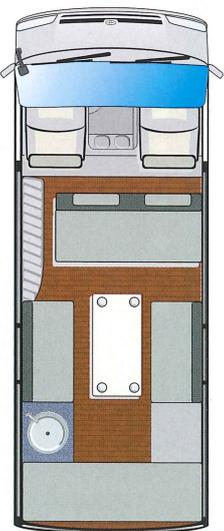
①蓋付のシンクは、使用しない時は調理台としても利用できる。②ダイニング右上部には収納棚が設置される。③調理台はスライド可動式になっており、使いたいときに引き出して使用し、使わないときは壁に沿って落とし込めば収納スペースが広く使えるようになる。④ダイネットは7人でゆったりとテーブルを囲めるスペース。⑤セカンドシートは前向き乗車も可能。サードシートのみベッドに展開することも可能で、そのサイズは1700×900mm。⑥セカンドシートとサードシートを展開させることで室内幅いっぱいのメインベッドとなる。サイズは1800×1700mmで大人3人が就寝できる。⑦リアスペースのリアチャイルドベッドは1700×680mmのサイズで、上下段共にベッドとして使用できる。子供はもちろん大人も就寝可能なスペースだ。
