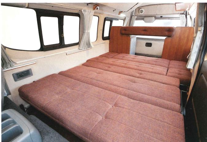
内高に余裕のあるハイルーフの利点を生かして2段ベッドを標準装備とし、ファミリー向けバンコンに仕立てたプロス。取りまわしのいい標準幅仕様に加えて、フロアベッドの横幅にゆとりを持たせたワイド幅仕様が追加された。マルチアクションのREVOLセカンドシートとソファアを組み合わせて対面ダイネットやベッドを作るには標準幅仕様と同じだが、セカンドシート幅が1200mmに拡張。長さも2m以上から1500mmに拡張。長さも2m以上で、大人3人で横になつても余裕がある。リヤ両サイドにキャビネットを振り分け、キッチンや調理設備をまとめたレイアウトはリヤゲート側からの使い勝手がいい。ラゲッジスペースも広く、上段ベッドを展開した状態でも余裕たっぷり。定評あるレイアウトはそのままに、ワイド幅のメリットである横方向へのゆとりが加わり、より魅力度がアップした。
