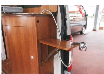
●シャワーヘッドは写真のように車外に引いて使える。リヤキャビネット端の折りたたみテーブルにシャワーホルダーが備わる
