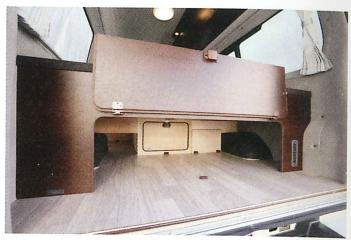
●シート下は大容量の収納スペース。リヤゲート側からもアクセスでき、ベッドマットを外せば、大きな荷物も楽に積み下ろしできる
