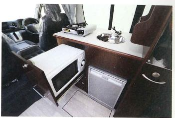
●エントランス前のキッチンカウンター。調理台は長さ・幅ともにゆとりがある。引き出し収納庫にオプションの電子レンジが収まる
