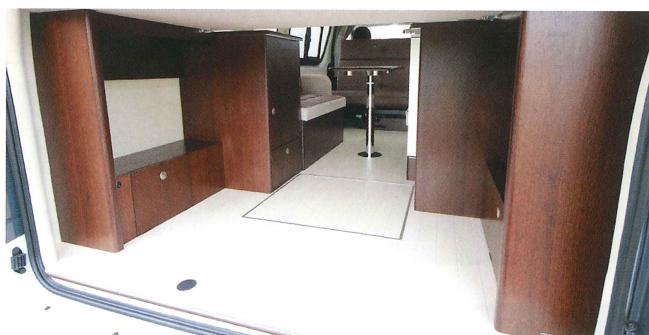
セカンドシートは走行中は前向き、ダイネット使用時は後ろ向きに。細かなリクライニングも可能で、長旅もラク。メインベッドは1500×2100mmと大人3人がゆったりと寝られるサイズ。サードシートは左右それぞれ2人掛け。このシートのみでのベッド展開も可能。子ども用のリヤベッドは1630×1120mmのサイズ。天井までの高さも充分で窮屈感はない。リヤベッドの下は旅行の荷物がたっぷり詰める。テーブルの天板とポールはシート下にスッポリ収納。
