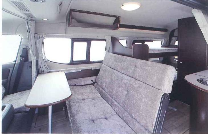
荷室やカセットトイレの設置などさまざまな用途に使えるマルチルームや、面倒なベッドメイクが不要の常設ベッドなど、大型のキャンピングカーではおなじみの装備をバンコンで再現するため、キャラバン最大の室内空間を誇るスーパーロングワイド幅ハイルーフを採用。定番のDXやキャンパ
