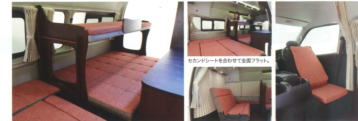
リヤには横向きのベンチを設置。簡単に2段ベッドへと展開できる。 セカンドシートを合わせて全面フラット。 セカンドシートは後ろ向きにセット可能。 フロントシートを利用したダイネット部。
