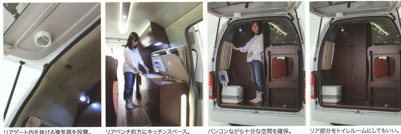
リアゲート内を抜ける換気扇を設置。 リアベンチ前方にキッチンスペース。 バンコンながら十分な空間を確保。 リア部分をトイレルームにしてもいい。
