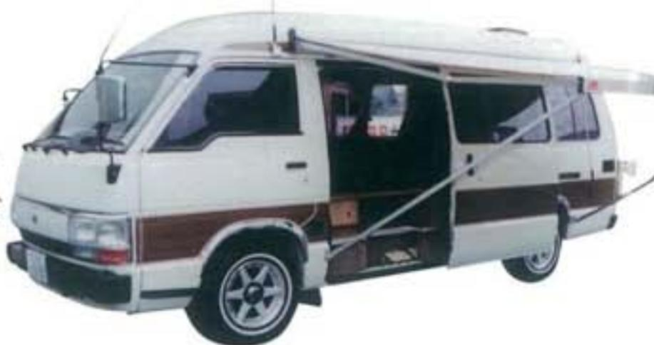
初代がリリースされたのは'89年。それまではE24系のキャラバン（ホーミー）ベースのバンコンをメインとしていたが、100系ハイエースの誕生に合わせてスーパー長を使って架装したのがきっかけ。そのときに採用されたのが、現在でもほぼ変わらないレイアウト。ダイネットは、反転したセカンドシートに横座りの対面シートの組み合わせ。後部右側にキッチンを備えるが、タイヤハウス上を覆う形でシンクと冷蔵庫を配置。さらにキャビネット内にテレビを組み込んだ。この効率のいい架装が空間に余裕を持たせ、ゆったりと過ごせるモデ
